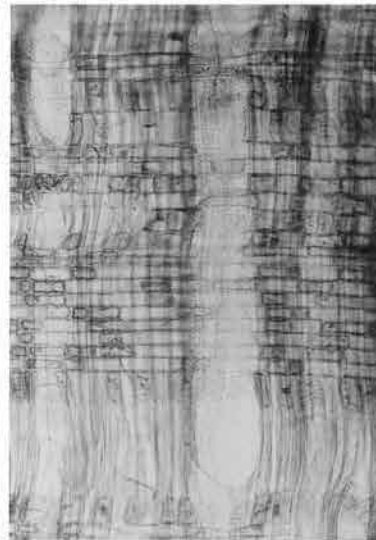
12c ヤナギ属(放射断面) 埋没林通し番号43 bar:0.2mm
