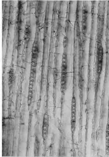
11b サワラ(接線断面) 木製品樹種No.12 bar:0.2mm
