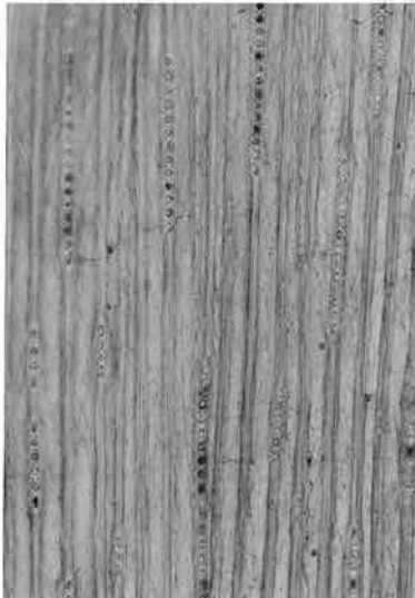
2b モミ属(接線断面) 木製品樹種No.25 bar:0.2mm
